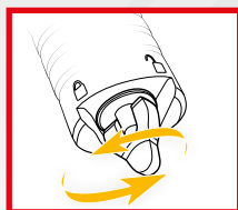
LEVA DI INCREMENTO POTENZA SERRAGGIO
